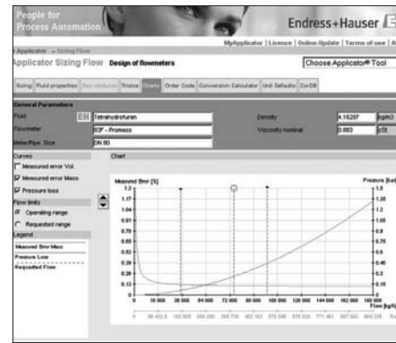
Controllo di perdite di pressione/errore di misura (esempio)
